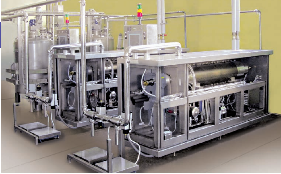
◀ Impianto di plastificazione margarine Tempermix HI700
